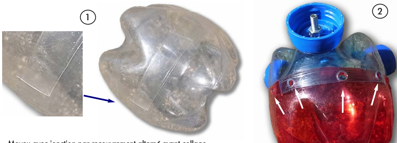
Jonction par recouvrement alterné puis solidarisée par des petits trous percés à chaud (flèches)
