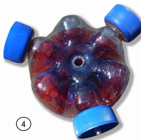
Moyeu d'un moulin à 3 ailes avec au centre le perçage (au fer à souder) du trou central pour le passage de l'axe du moulin
