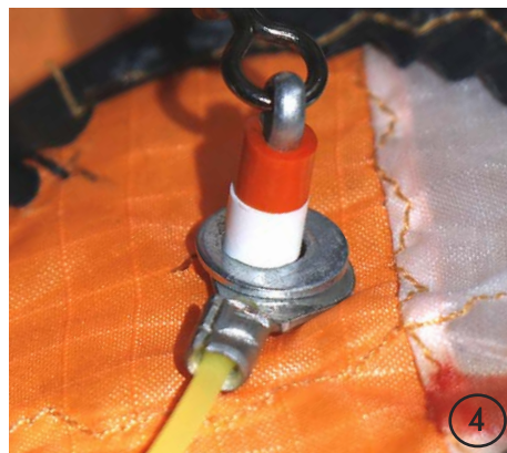
La cosse et le fil de nylon serti dedans, les rondelles et les perles de blocage
